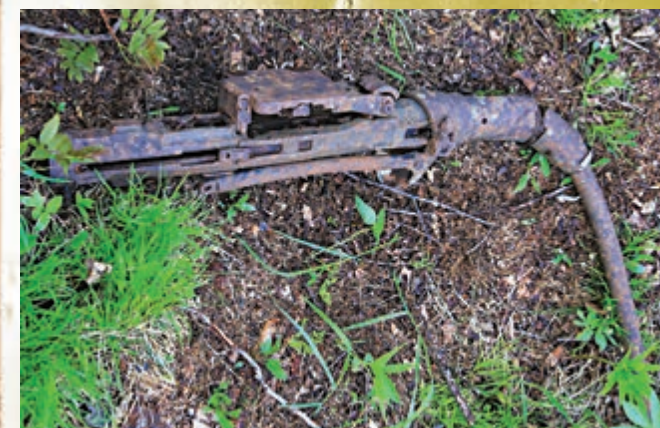
Пушка НР-23 с гнутым стволом
