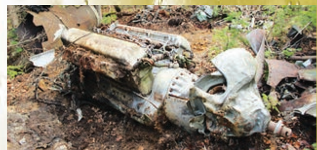
Двигатель штурмовика Ил-2КР № АМ38Ф
