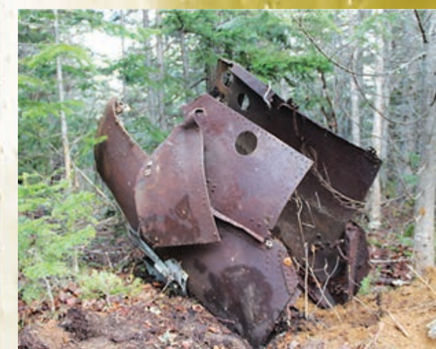
Особенность данного экземпляра в том, что у него была бронированная кабина не только пилота (фотография сверху), но и стрелка (фотография снизу)
